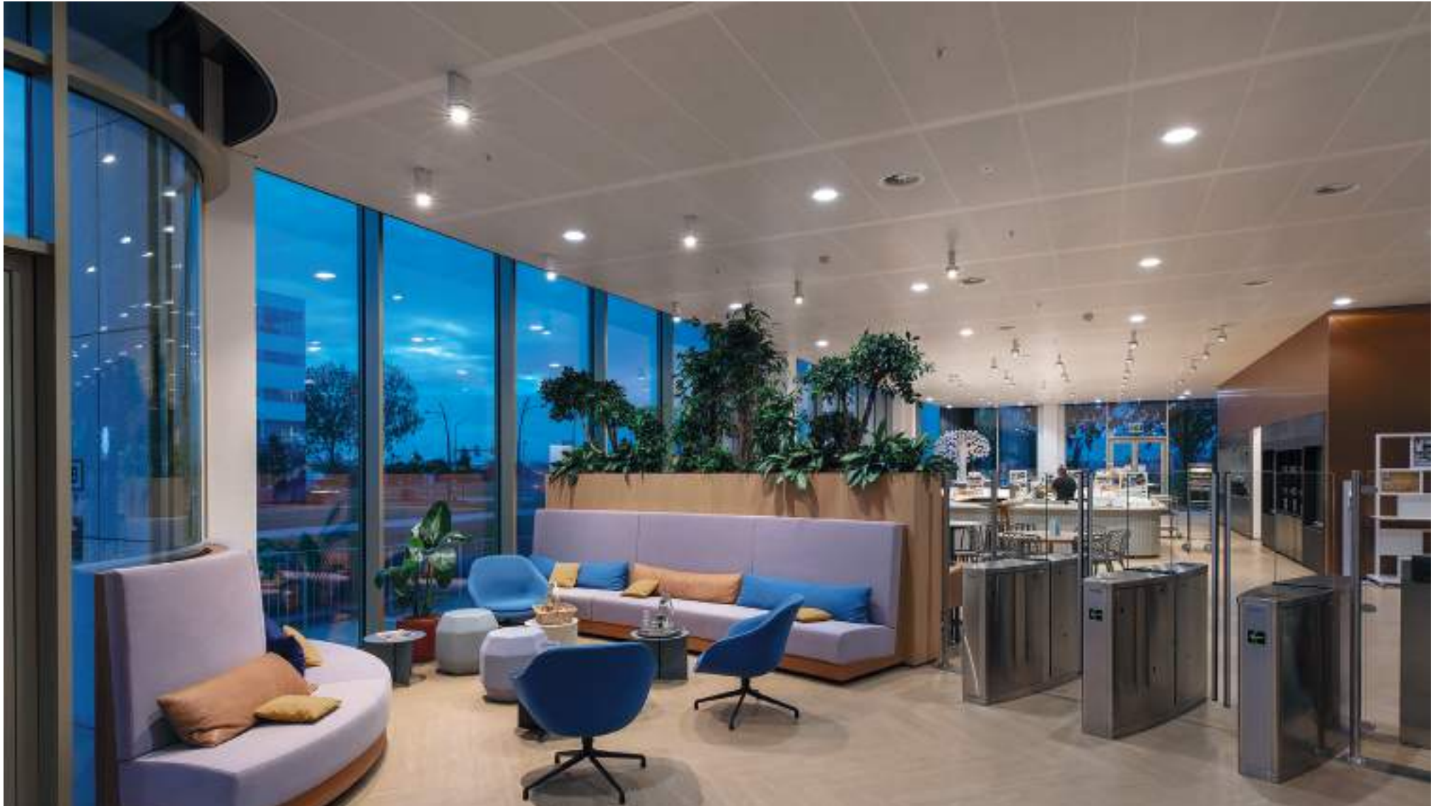
DANONE | HOOFDDORP | BANDRASTER SYSTEEM KLIMAATPLAFOND
